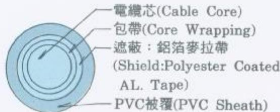
本電纜係彩色聚乙烯(PE)絕緣聚氯乙烯(PVC)被覆之簇型星絞電纜，用於建築物內電信配線，簡稱PE-PVC屋內電纜，其特點安全性佳。
