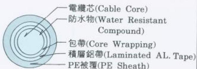
本電纜係發泡、充實聚乙烯雙層絕緣充膠型電纜，用作市內電信地下線路，簡稱FS-JF-LAP市內電纜，其特點為防水性佳，氣密性優，抗蝕性，絕緣性良好，增加電纜之安全性及壽命。
